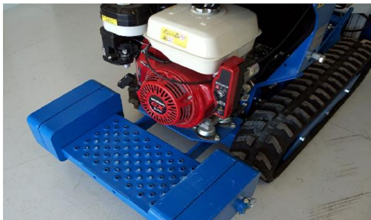
Plateforme avec 4 contrepoids amovibles de 25 kg
